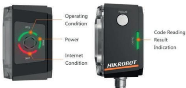
Серия ID3000 оснащена несколькими наборами световых индикаторов состояния рабочего процесса. Верхний кольцевой индикатор оснащен водонепроницаемой кнопкой, а боковой индикатор результатов считывания в режиме реального времени виден под разными углами.
