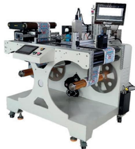
7-дюймовый цветной сенсорный экран и мощный ПЛК. Установка рабочих параметров, контроль состояния, система самодиагностики. Постоянный контроль натяжения материала. Функция плавного разгона и торможения с предотвращением провисания материала. Перемотчик RW500 можно оснастить маркировочным оборудованием, например таким как промышленный струйный принтер УФ-печати ALT500, или любой маркировочный принтер (TIJ, CIJ, TTO, Laser) по желанию заказчика.
