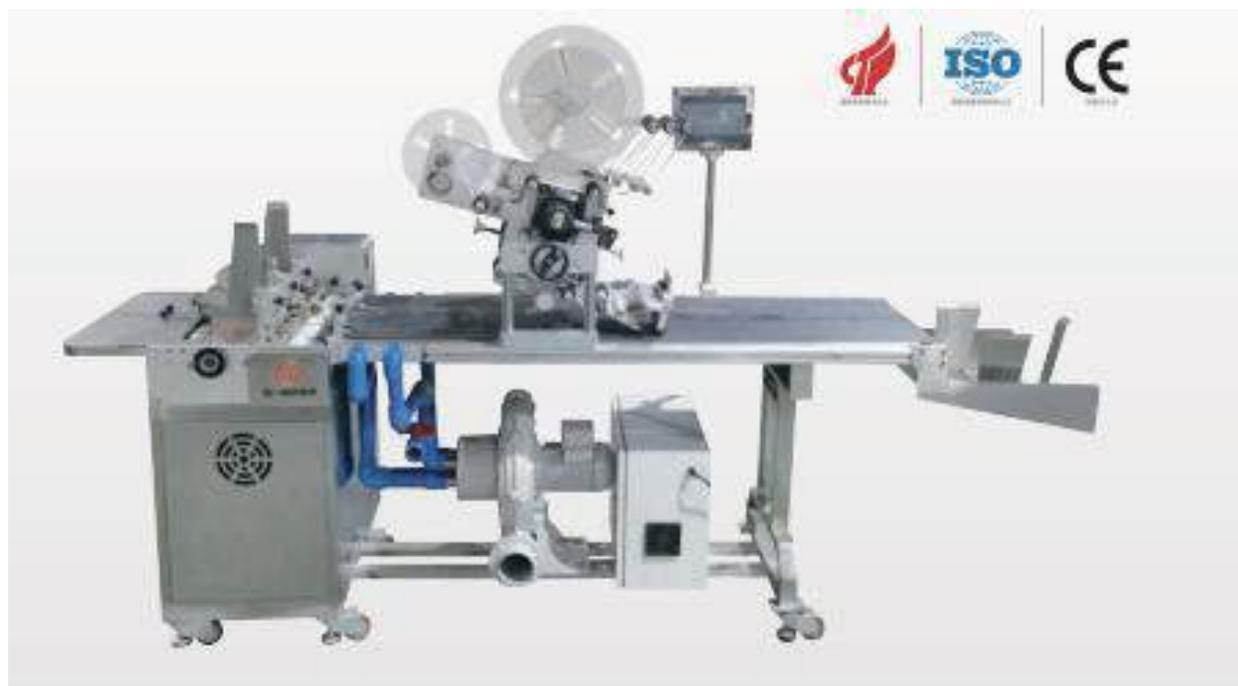
Этикетировочная машина с пролистывателем представляет собой устройство, предназначенное для автоматического нанесения этикеток на товар при пролистывании.
